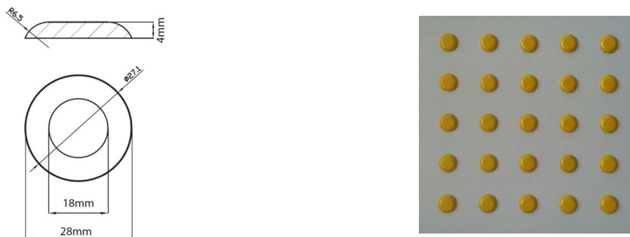
Фиг. 10. Примерен профил, подреждане и фиксиране на профилни елементи върху готови настилки за изпълнение на тактилни ивици за внимание (предупреждение)
